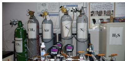
図. 混合ガスハイドレート化装置の一部
