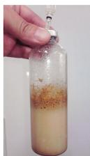
図. バイアル瓶によるメタン発酵実験
