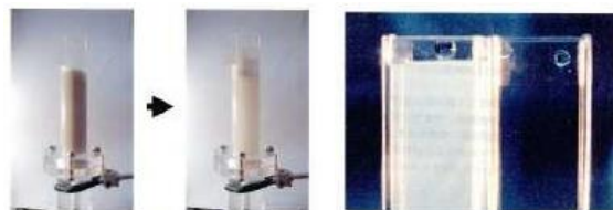
(左)新規分離技術(マイクロバブル浮選)の光景 (右)浮選前後の溶液の様子、左が浮選前
